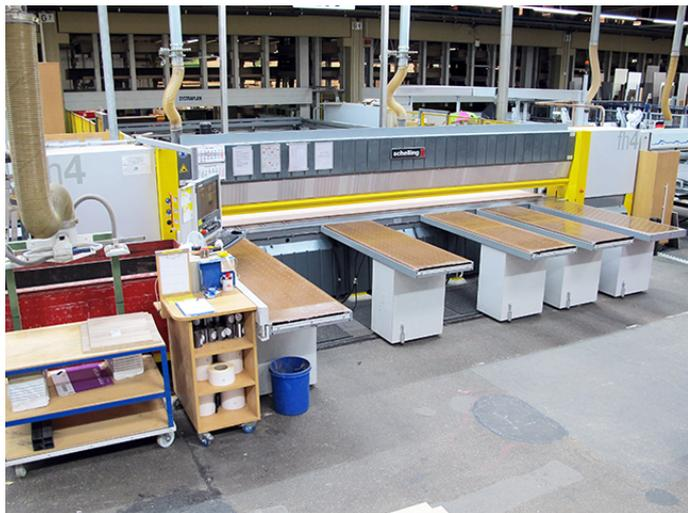
Largeur max. d'usinage 5600 mm
