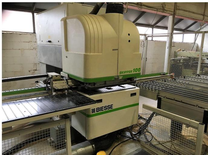
Zone d'usinage axe X 3000 mm
