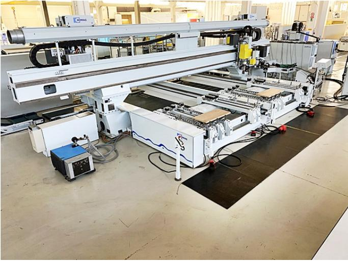
Zone d'usinage axe X 5000 mm
