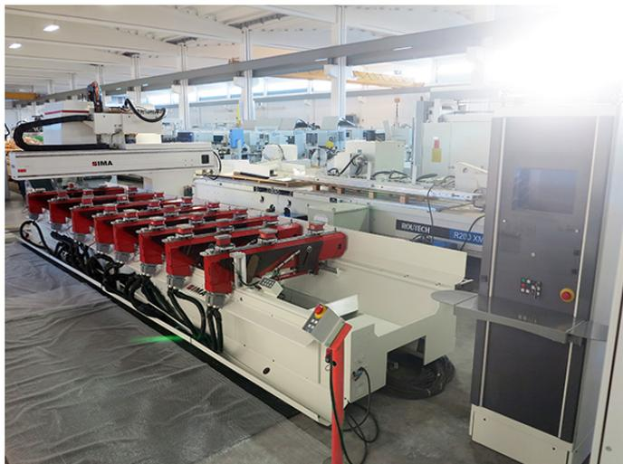
Zone d'usinage axe X 6000 mm
