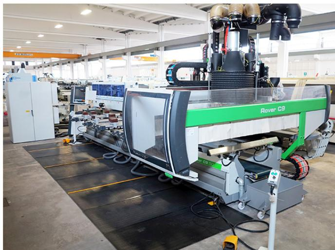
Zone d'usinage axe X 4600 mm
