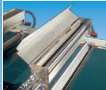
TESTA A VELARE A CADUTA STANDARD Standard "free fall" coating head • Cabezal de cortina de caída estándar Tête à chute libre standard • Standard Freifall-Giesskopf
