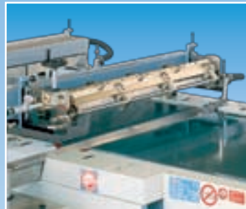
TESTA A VELARE UNIVERSALE PESANTE Heavy universal head • Cabezal de cortina universal pesado Tête d'application universelle lourde • Schwere Universal-Giesskopf
