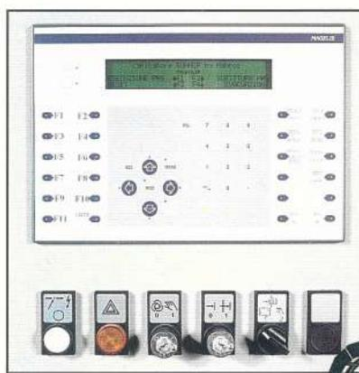
Il controllo elettronico gestisce completamente il funzionamento del sistema ed esegue l'interpolazione degli assi. Predisposizione per il collegamento al supervisore di linea.
