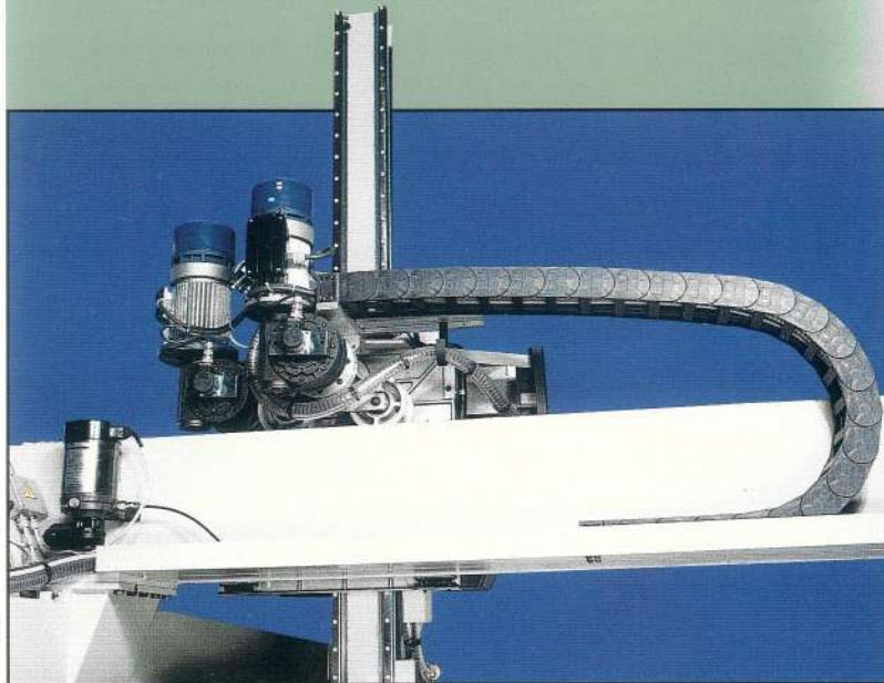
Le guide prismatiche a ricircolo di sfere consentono spostamenti veloci e precisi; la lubrificazione dei pattini avviene automaticamente senza necessità di alcuna manutenzione.
