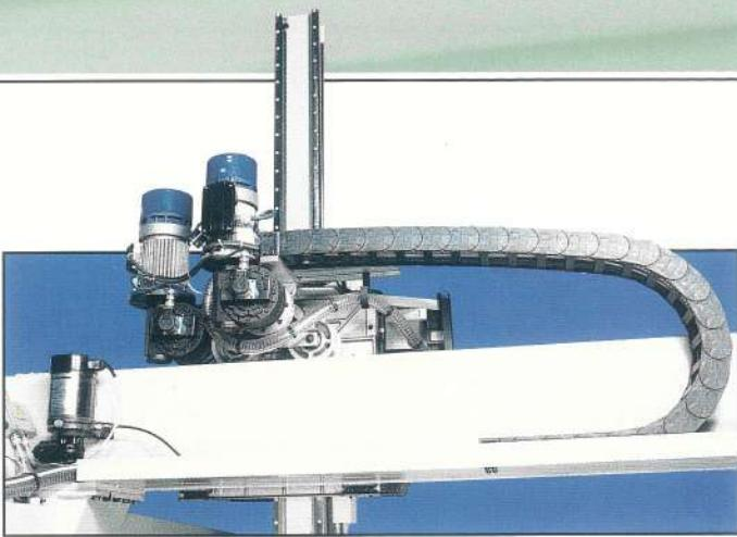
Le guide prismatiche a ricirculo di sfere consentono spostamenti veloci e precisi; la lubrificazione dei pattini avviene automaticamente senza necessità di alcuna manutenzione.
