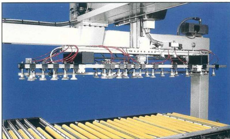
Sistema di presa a ventose che si regola automaticamente in funzione delle dimensioni del pannello.
