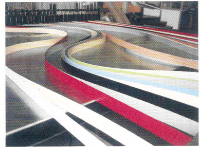
Magazzino bordi fino a 24 rotoli Edge magazine up to 24 coils
