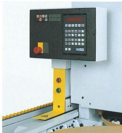
Das neuentwickelte modulare Steuerungssystem bietet neben hohem Bedienkomfort auch optimale Servicefreundlichkeit. So sind beide Maschinen bereits voll für den zukunftsgerichteten Tele-Service ausgerüstet. Die Rot-Grün-Ampelsteuerung zeigt dem Bediener an, wann das nächste Werkstück zu beschicken ist.
