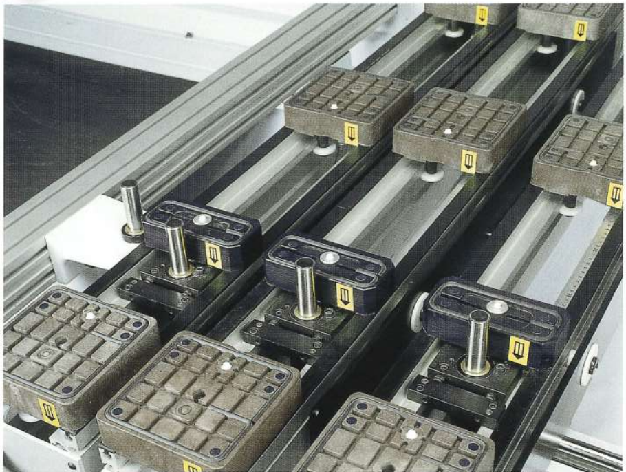
Vordere Anschlagreihe für Schmalteile
