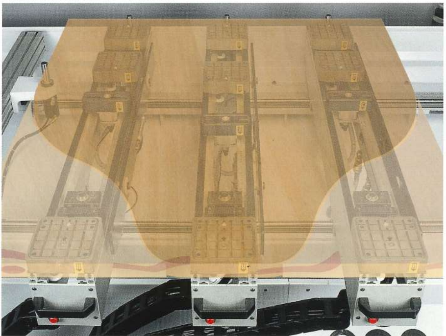
Hintere Anschlagreihe für großflächige Werkstücke
