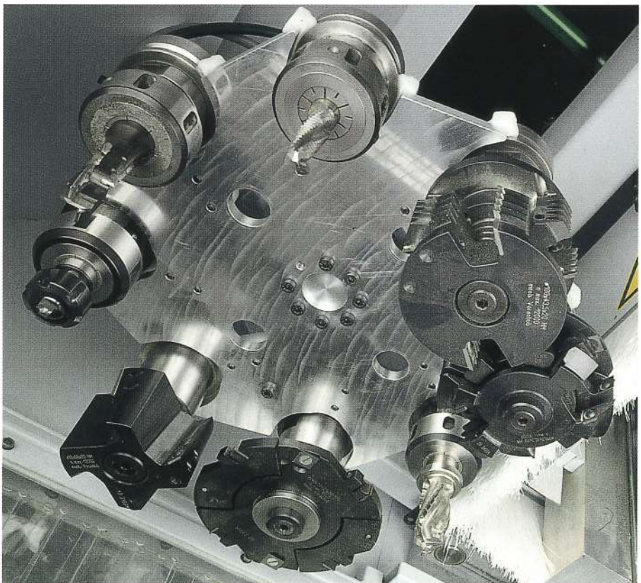
8-fach Magazin in X- und Y-Richtung mitfahrend
