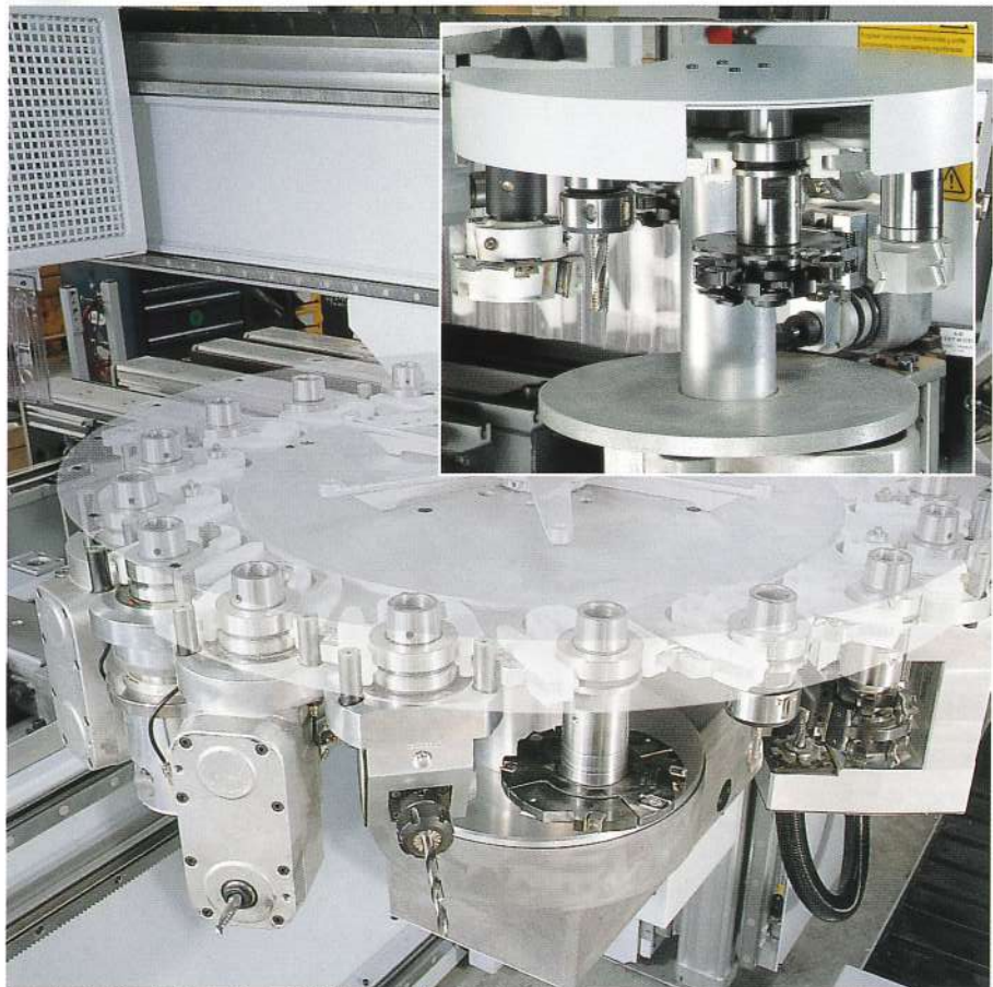
8- oder 18-fach Magazin in X-Richtung mitfahrend
