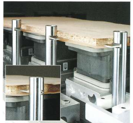
Schwenkbarer pneumatischer Anschlag für Deckschichtüberstand
