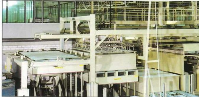
STATION SUPPLEMENTAIRE (en option). Le chariot porte-ventouses dispose d'une course supplémentaire afin de permettre le déchargement du panneau martyr ou le chargement de panneaux à partir d'une deuxième station de chargement.
