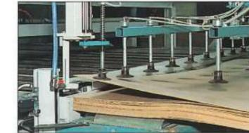
Ventouse auxiliaire afin de faciliter le décollement des panneaux, avant la phase de préhension par le chargeur à ventouses.
