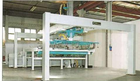
Dispositif de chargement à ventouses avec prélèvement direct du panneaux sur la pile (en option)
