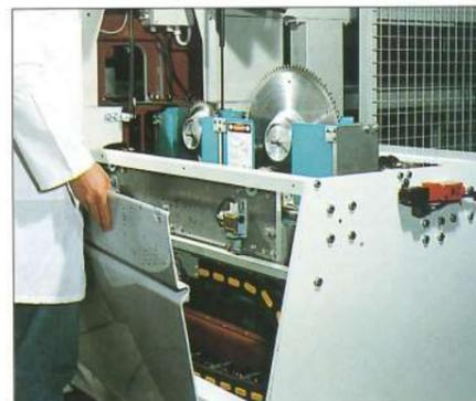
Carters latéraux de forme et matériaux spéciaux, pour diminuer les bruits: permettant en outre l'accessibilité maximale à toutes les parties de la machine.
