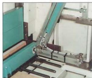
Dispositif à spatule d'expulsion pour le déchargement des chutes de rafraîchissement arrière (en option).
