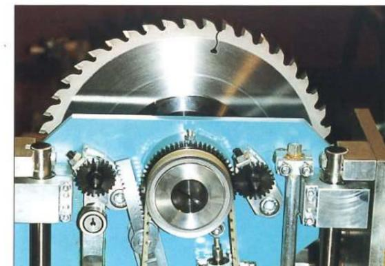
Régulation électrique de l'inciseur aussi bien latérale qu'en hauteur, avec la lame en mouvement, et visualisation digitale (en option).
