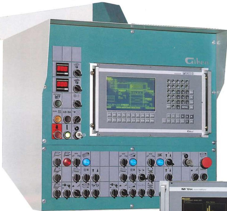
Accessibilité maximale et ergonomie des commandes. Le pupitre de contrôle et le programmeur électronique sont montés sur un panneau positionné à côté du guide d'équerre du cadre, pivotable sur 180°.
