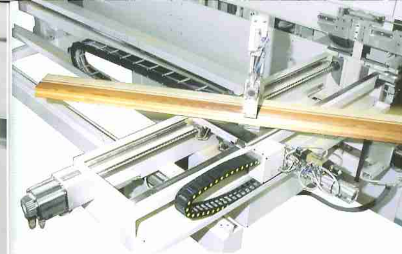
La robustezza del carro permette la lavorazione in doppio Strong construction of the carriage allows to machine in double Die robuste Bauweise des Schlittens erlaubt eine paarweise Bearbeitung La robustez del carro permite la elaboración doble La robustesse du chariot permet l'usinage de deux pièces simultanément
