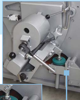
Abb. 12 Höheneinstellung der Sägewelle durch Elektrohubspindeltrieb
