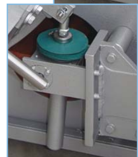
Abb. 12 Höheneinstellung der Sägewelle durch Elektrohubspindeltrieb
