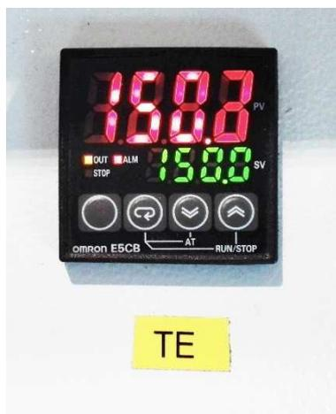
**Display per regolazione temperatura barra saldante**
