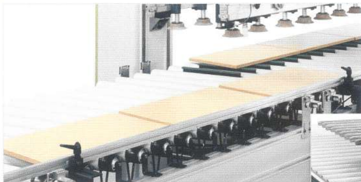
Transfer con sistema a pettine per carico pannelli in doppia fila.
