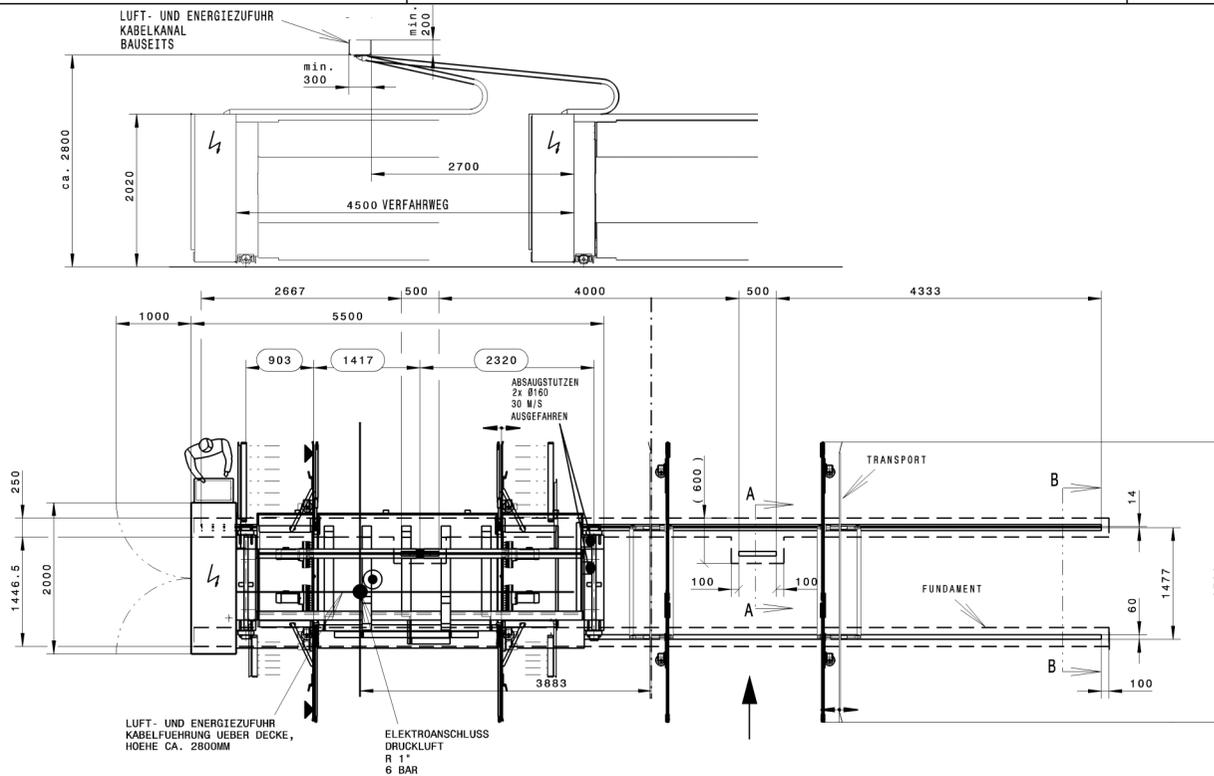
Die Produktionseinrichtung ist ohne die in diesem Plan eingezeichneten und von HOMAG gelieferten Sicherheitsabschränkungen nicht CE-konform und darf nicht betrieben werden. Als bauseitige Zugangsverhinderung sind nur fest mit dem Hallenboden und der Hallendecke verankerte unbewegliche Wände zulässig.
