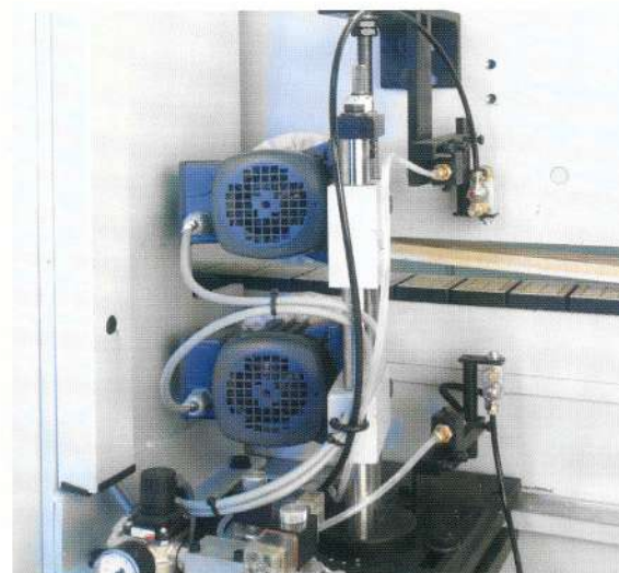
Unità di finitura FA 11 Composta da raschiatore per giunzione colla, dispositivo di applicazione del liquido anti-adesivante e spazzola per eliminare i residui di colla.
