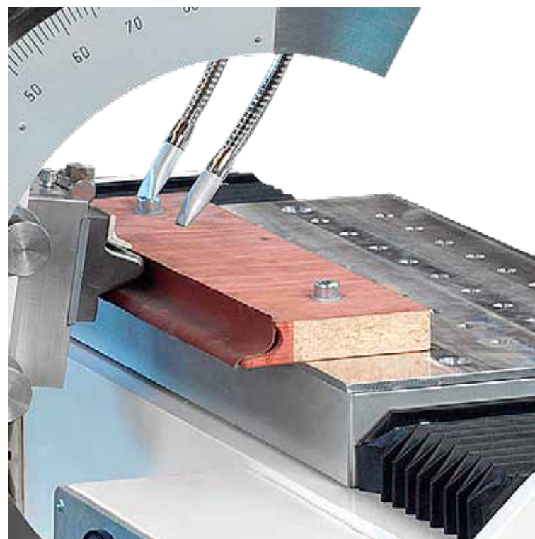
Ein Gegenprofil aus Metall wird mit Hilfe eines Musterwerkstückes an der PWS-T eingeschliffen.
