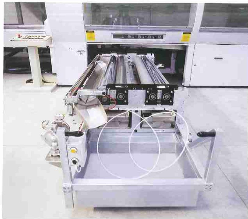
Sistema di recupero vernice (brevettato) e di pulizia del tappeto ad estrazione longitudinale. Il doppio rullo reverse autopulente abbate il consumo di solvente ed il tempo di pulizia.
