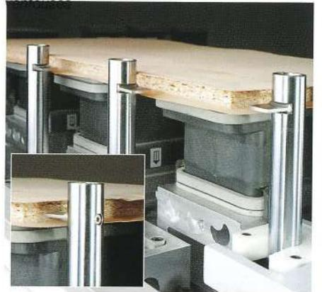
Butée pneumatique pivotante pour dépassement du revêtement
