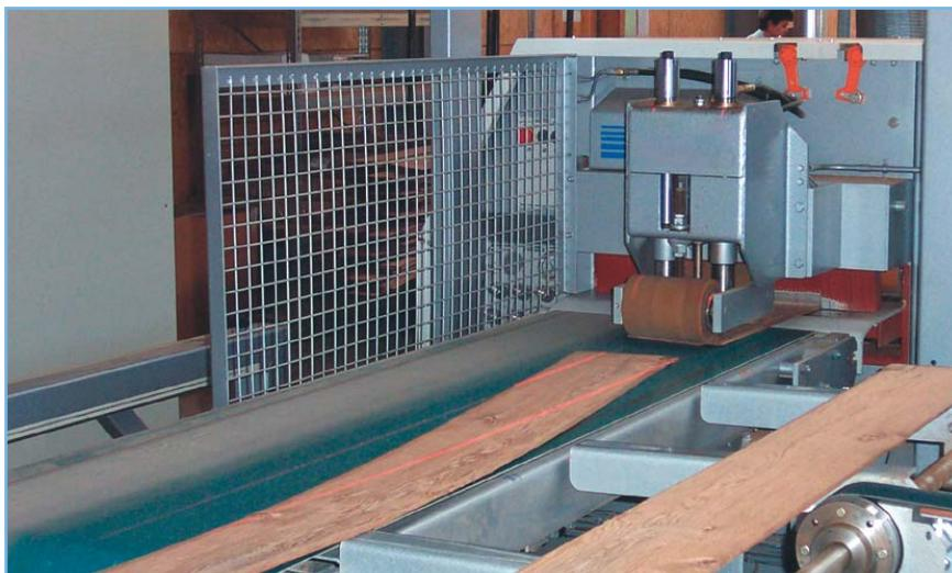
Fig. 41 Impianto per la sezionatura di lamelle superiori per parquet prefiniti, composto da sega a lame multiple K34G/800 in versione speciale con lama sega regolabile e ...
