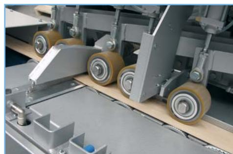
Fig. 42 ... impianto di troncatura a comando CNC concatenato tramite meccanizzazione
