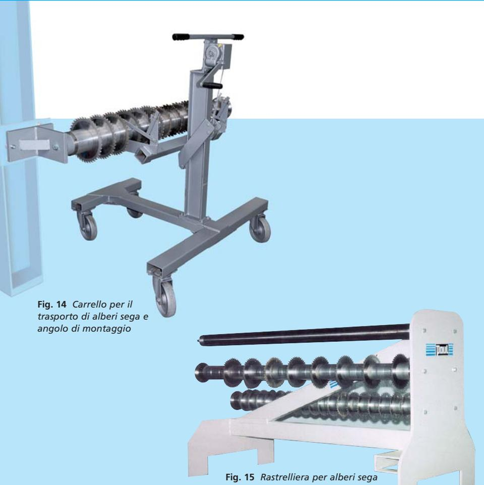
Fig. 14 Carrello per il trasporto di alberi sega e angolo di montaggio
