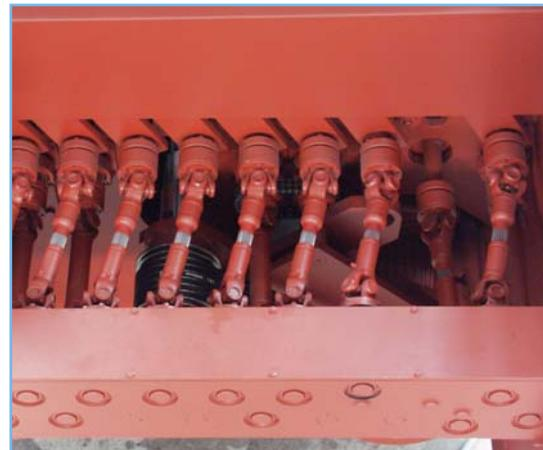
Fig. 20 Azionamento dei rulli d'avanzamento tramite trasmissioni cardaniche
