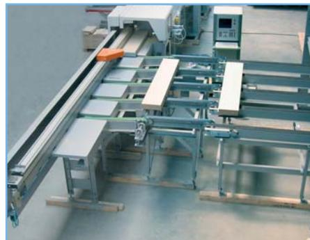
Fig. 36 Variabile taglio su misura con impianto di troncatura a comando CNC
