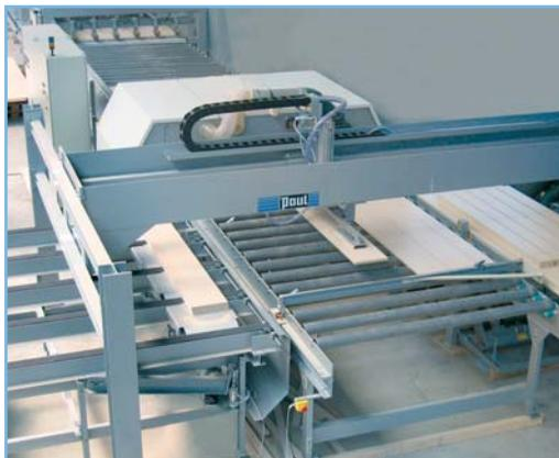
Fig. 35 Impilatura di strisce con portale sottovuoto dopo sega a lame multiple K34G/2200 con caricamento automatico
