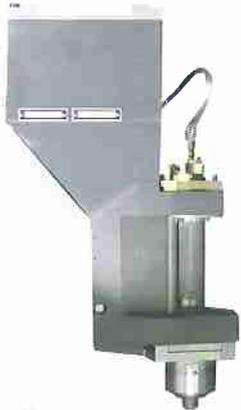
Leimbehältervorderteil zum Wechseln. Alternativ teflonbeschichtet für der Verarbeitung von PU-Leim
