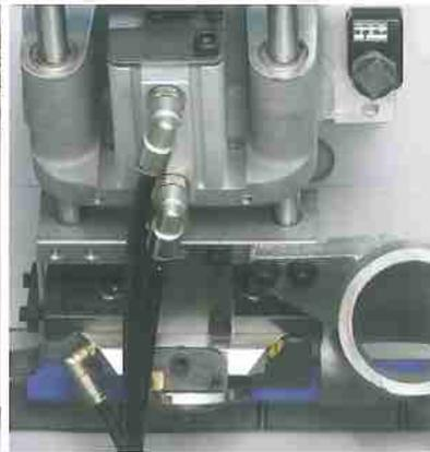
Automatische Verstellung Bündig-/Überstandskappen für schnellen Wechsel zwischen dem Bündigkappen von Massivleisten oder Einlegeböden und dem Kappen mit Überstand (zum Nachfräsen mit Formfräsaggregat)
