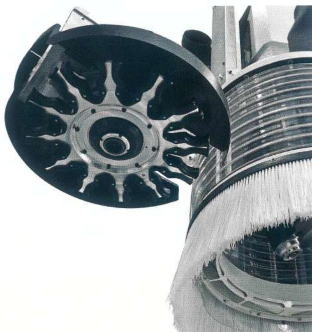
Il magazzino Rapid 12 "on board" montato direttamente sull'elettromandrino principale consente il cambio dell'utensile in tempo mascherato, durante la foratura o la fresatura ausiliaria.
