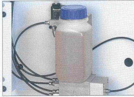
**Unità di lubrificazione centralizzata**
