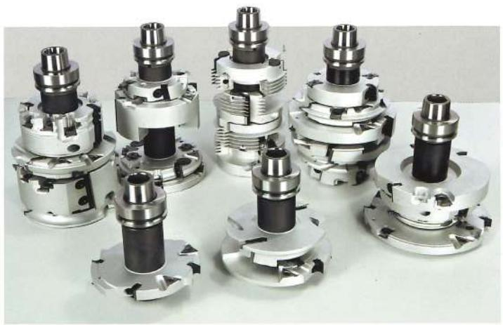
Usinage par des outils à profil double, pour réduire le recours au changement d'outils et augmenter la productivité.
