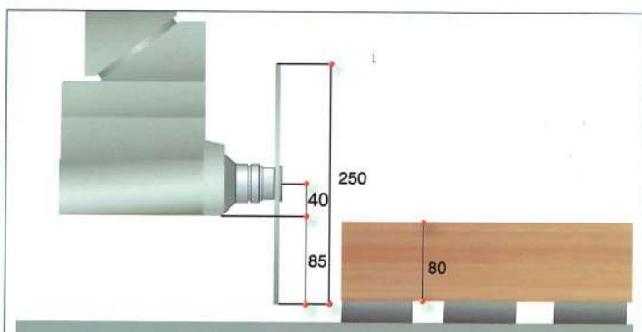
Grâce aux dimensions d'encombrement réduites de l'électromandrin à 5 axes Prisma K, les usinages horizontaux peuvent être exécutés sans soulever la pièce et en exploitant au maximum la course Z ; il est également possible d'effectuer des coupes à la lame sur des épaisseurs importantes.
