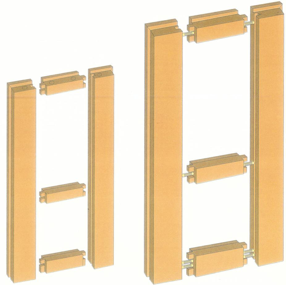
Taglio, fresatura e foratura di montanti e traversi.
