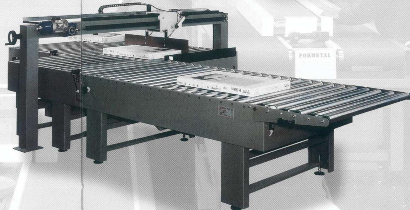
Smistatore automatico con spintore elettromeccanico.
