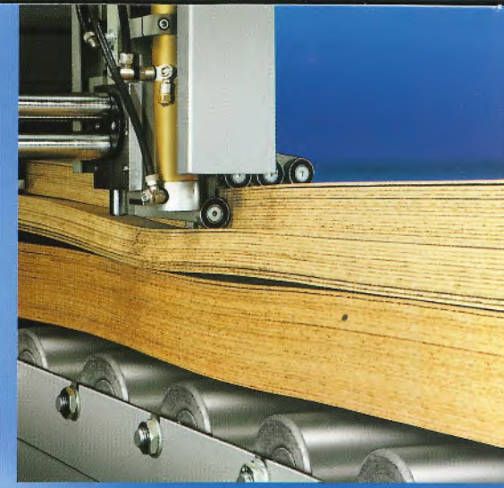
CNC Mikroeinschub auch für dünne Platten CNC micro-infeed for thin panels too
