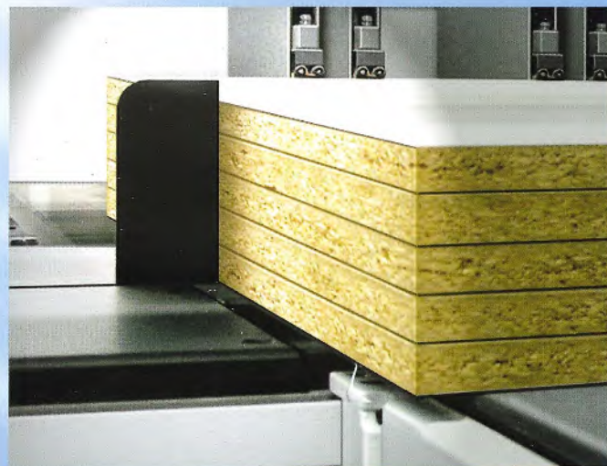
Zentrale Winkelandrückvorrichtung mit einstellbarem Druck Central side pressure device with adjustable pressure
