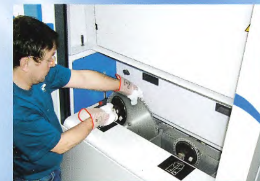
Powerloc Schnellspannsystem Für schnellen, sicheren Sägeblattwechsel Powerloc quick-release clamping system for fast, reliable saw blade changeover
