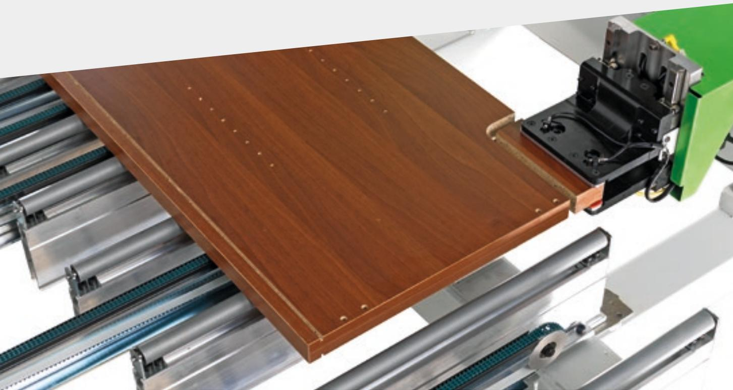
Totale flessibilità per la lavorazione di pannelli di diverse dimensioni e spessore. Lavorazioni senza interruzioni, sia sulla parte superiore che inferiore contemporaneamente, senza la necessità di ripassare i pannelli più volte in macchina.
