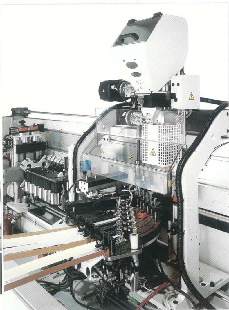
Gruppo incollaggio SP3/SF per pannello con profilo dritto e softformato
