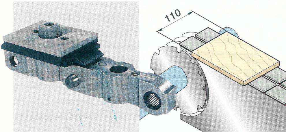
Catena ad alte prestazioni, costituita da robustissimi elementi in acciaio sinterizzato. Perno di giunzione su cuscinetti lubrificati a vita. Larghezza pezzi min. 110 mm (opzionale)
