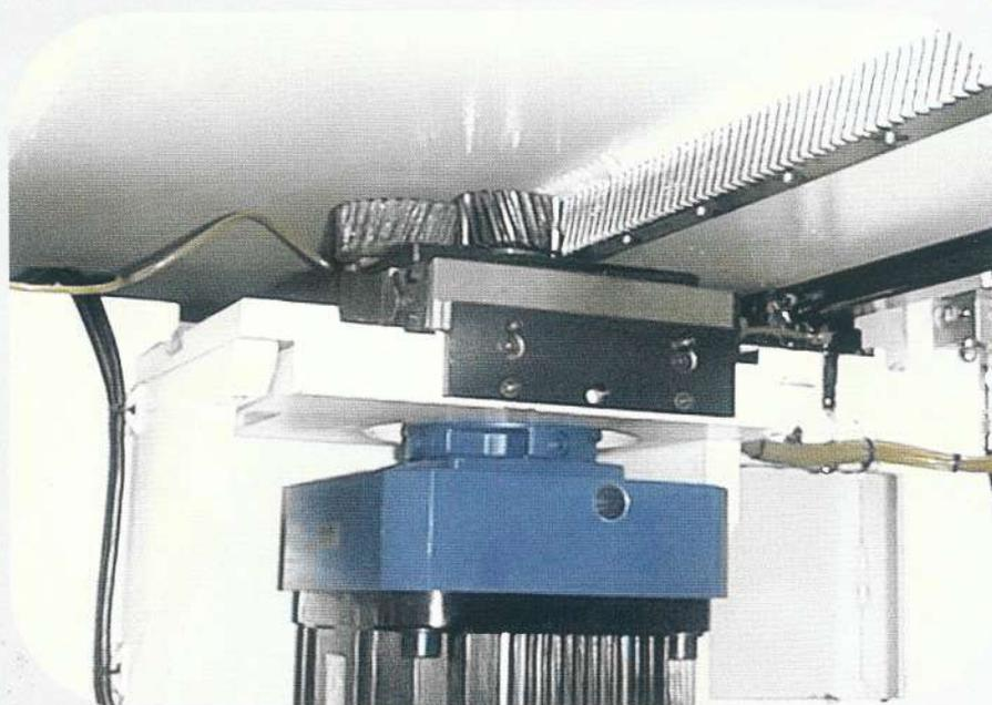
Les groupes opérateurs vont en direction X actionnés par des moteurs sans balais au moyen d'un système pignon-crémaillère sur 2 glissières prismatiques de 30 mm.
