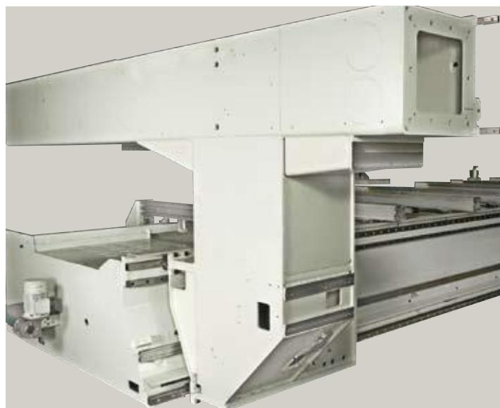
Basamento e montante mobile sono realizzati in carpenteria di acciaio eletrosaldato e stabilizzato con lamiera di grosso spessore ed opportune nervature di irrigidimento. Tutte le lavorazioni meccaniche vengono eseguite su centri di lavoro CNC in un unico posizionamento per garantire le rigorose tolleranze di planarità, perpendicolarità e precisione.
