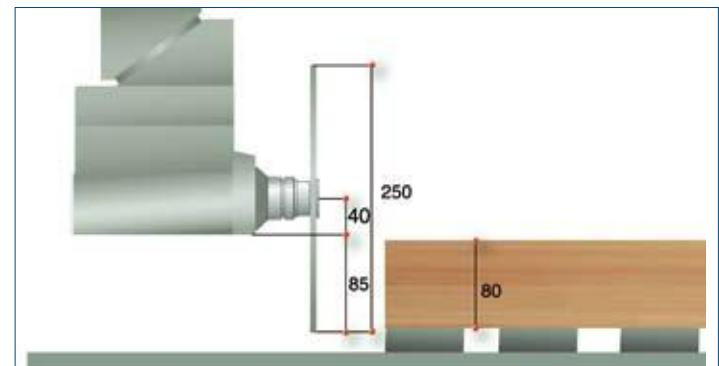
Gracias a las reducidas dimensiones del electromandril de 5 ejes, Prisma K, pueden realizarse trabajos horizontales sin levantar el tablero aprovechando al máximo la carrera Z, así como realizar cortes de la hoja en tableros de gran grosor.
