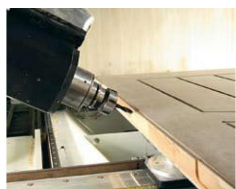
Prisma permette di utilizzare lo stesso utensile in posizione orizzontale, verticale o su piani inclinati eliminando tutti gli aggregati, riducendo l'impiego del cambio utensile e velocizzando la produzione.
