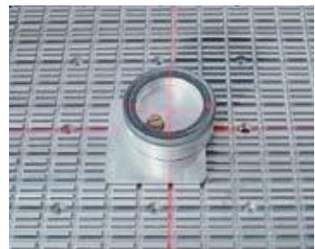
Il piano, direttamente lavorato sulla macchina, garantisce una assoluta precisione ed una perfetta planarità nel tempo, grazie alle sue caratteristiche di elevata rigidezza. Ideale anche per lavorazioni di plastica, resine e leghe leggere.
