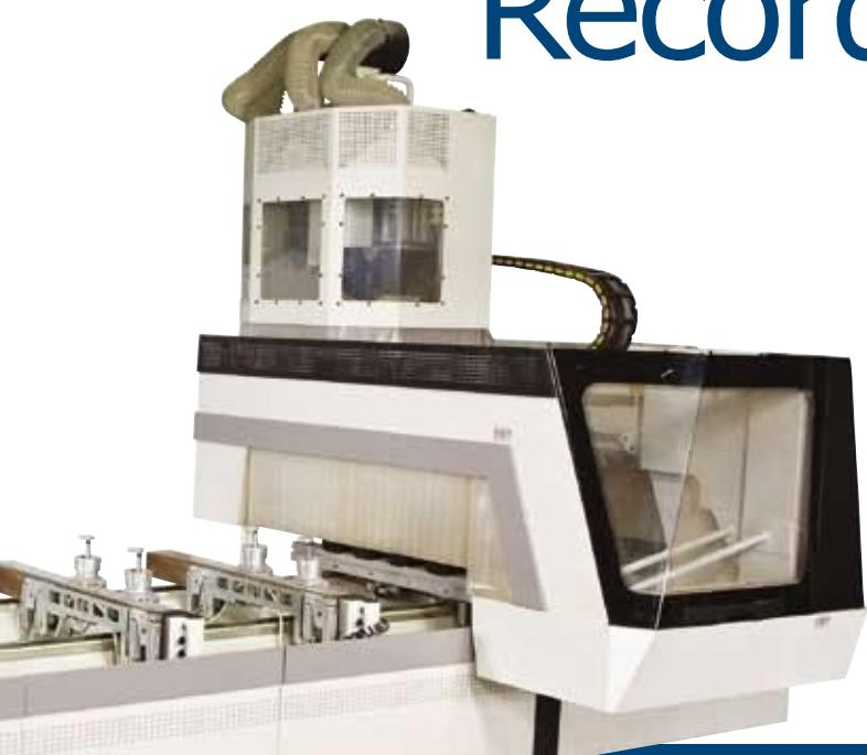
Record 240 NT TVN è la soluzione ideale per chi necessita un sistema pratico e flessibile per fissare, con rapidità e solidità, dai pezzi stretti a quelli larghi, dagli elementi diritti a quelli ad arco, grazie alla possibilità di attrezzare le barre sia con ventose per il vuoto che con morsetti pneumatici.
