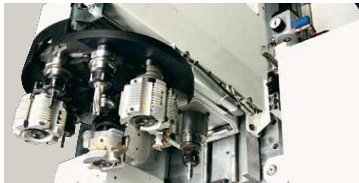
**PBTC:** unità di fresatura ausiliaria con cambio utensili automatico per velocizzare il processo produttivo.
