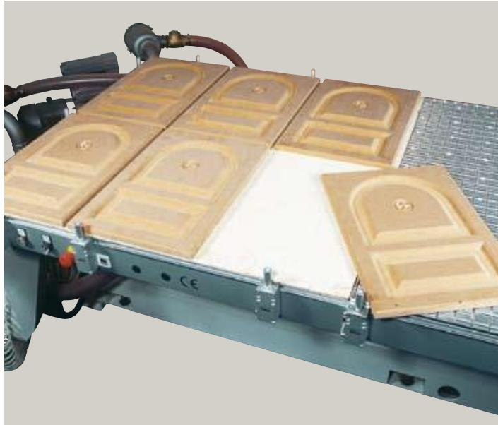
Una solida base d'appoggio in grado di offrire un'altissima capacità di vuoto: il piano ideale per un bloccaggio pezzi nella lavorazione in nesting. Caratterizzato dall'esclusivo profilo in alluminio, il piano garantisce totale stabilità nel tempo ed una portata di vuoto costante in ogni sua zona.
