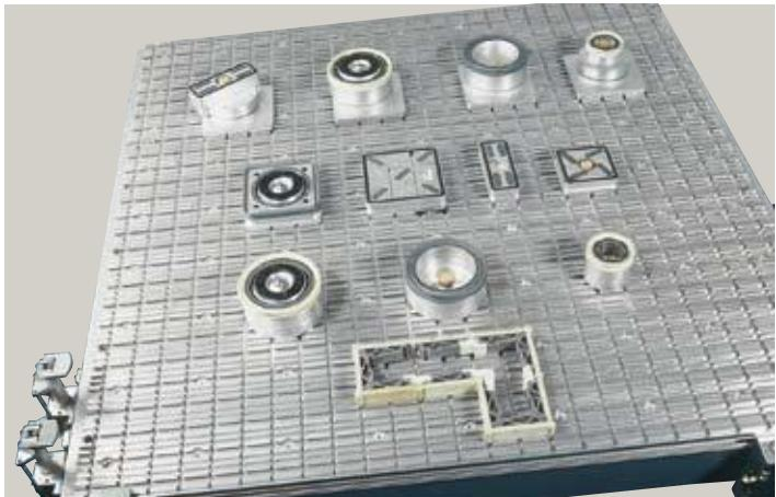
Una serie di fori filettati (passo 120 mm) offrono un'ancoraggio ideale per tutte le attrezzature di bloccaggio.
