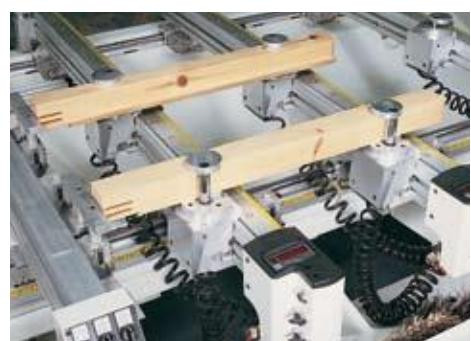
Per una produzione flessibile di finestre è necessario disporre di un sistema pratico, veloce ed intuitivo, che permetta di adattarsi in maniera rapida al variare delle dimensioni di ogni singola finestra. TVN SET è la piena risposta a questa esigenza. Attrezzato il piano con ventose o morsetti, al variare delle dimensioni del prodotto, è sufficiente modificare le quote nel programma parametrico e le barre si configurano per le nuove dimensioni.
