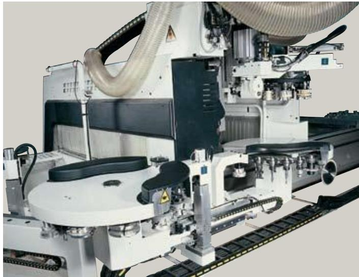
Entrambe le unità operatrici possono prelevare utensili dai magazzini posizionati sul montante mobile rendendo la macchina sempre pronta per qualsiasi impiego.
