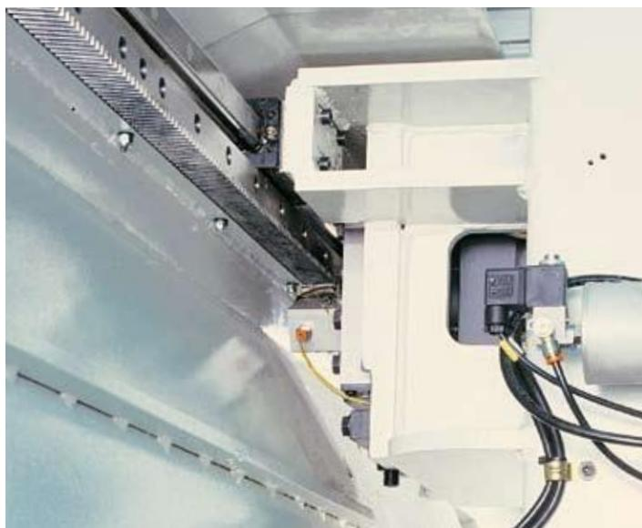
Cremagliere a denti elicoidali per la massima precisione nei movimenti ad alta velocità.
