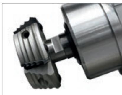
Gestione pneumatica di lavorazione con 4 posizionamenti automatici del profilo utensile.
