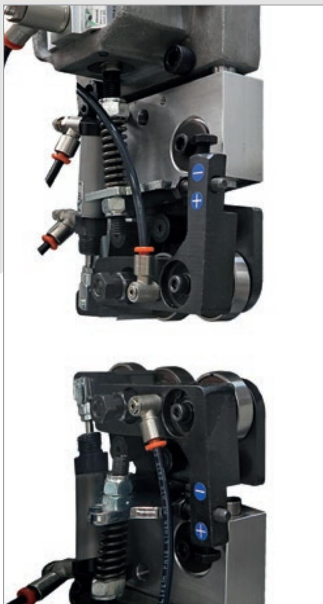
Il **Gruppo Raschiacolla** per rimuovere gli eccessi di colla nella parte superiore ed inferiore del pannello, è l'unico sul mercato dotato di 4 cilindri pneumatici per un'elevata qualità di finitura.
