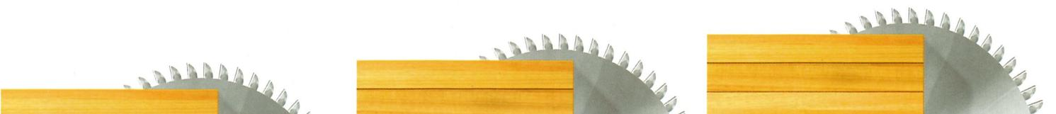
Bestmögliche Schnittqualität durch automatische Festlegung und automatische Ansteuerung des Hauptsägeblattüberstandes über das zu schneidende Material.
