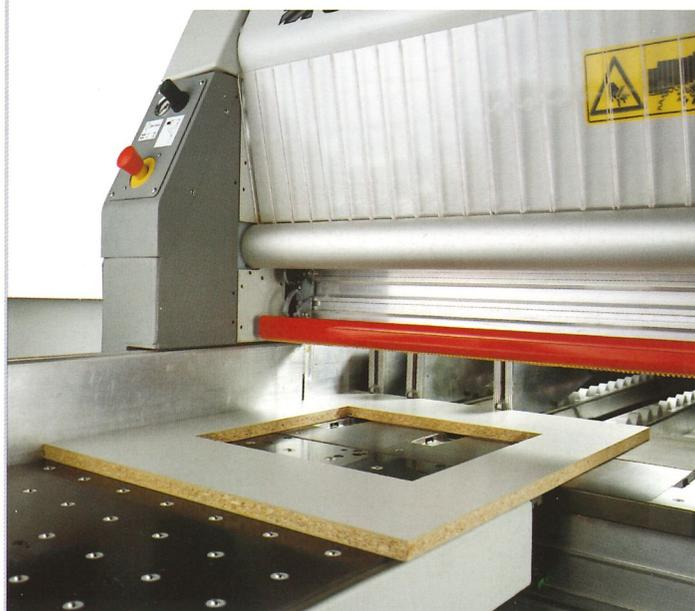
Software für Lichtausschnitte und Einsatznuten (hierfür ist auch die Nuteinrichtung erforderlich). Die Programme können in der Steuerung abgespeichert werden.
