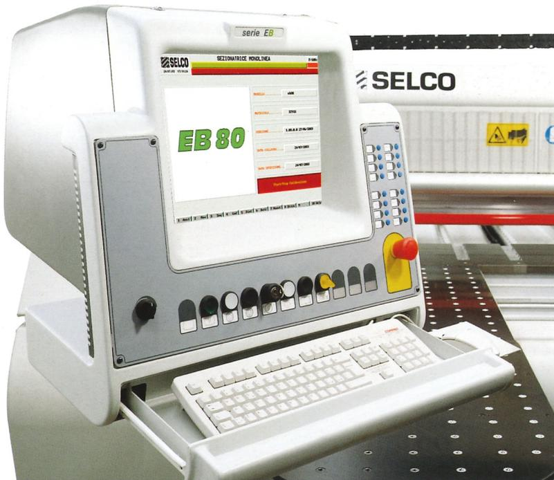
Maschinensteuerung auf PC-Basis mit 15" Bildschirm und Multitasking Betriebssystem Windows 95/98/2000/NT/Xp.
