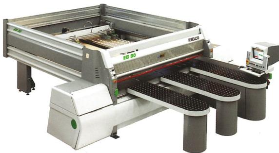
Maschine in Rechtsausführung mit Winkelanschlag rechts.
