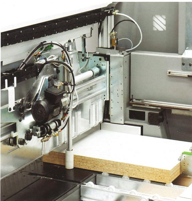
Winkelanpressvorrichtung mit einer gummierten Andruckrolle (zur Schonung der Kanten) zum rechtwinkligen Ablängen von Streifen. Einstellbarer Kombinationsdruck von Elektromotor und Pneumatikzylinder mit Voreinstellung.
