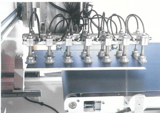
Scarico pannelli mediante ventose e nastro di trasporto
