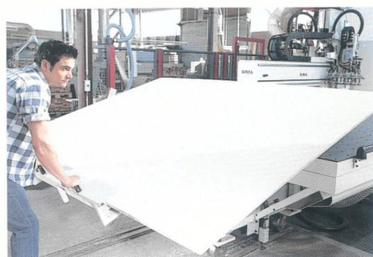
Carico con dispositivo di orientamento
