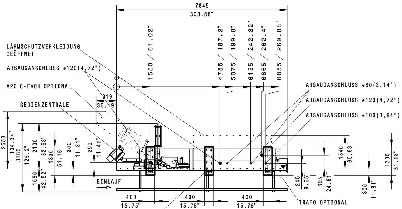
BODENBELASTUNG CA 0.2-0.3 N/MM2 IM BEREICH DER MASCHINENBETTEN MIN. BETONDICKE = 200 MM
