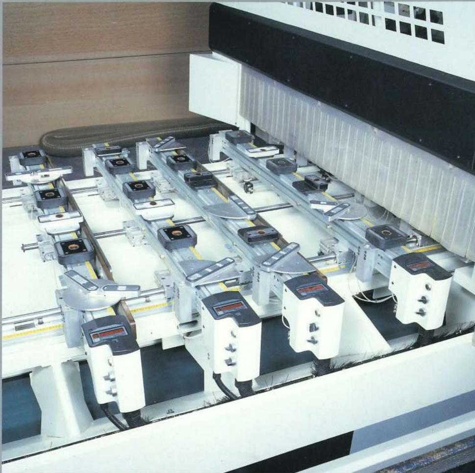
Il piano TVN permette di aggiungere tutte le ventose necessarie per quantità e tipologia e di passare velocemente dal fissaggio con ventose al fissaggio con un'ampia gamma di morsetti, senza l'impiego di chiavi o altri strumenti: **l'aggancio avviene pneumaticamente in maniera automatica.**
