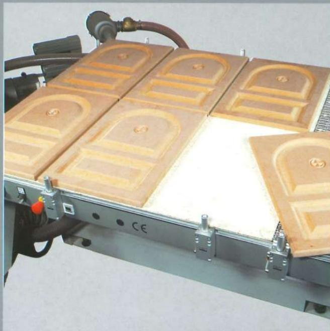
Una solida base di appoggio in grado di offrire un'altissima capacità di vuoto: il piano ideale per un bloccaggio tramite traspirazione.
