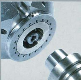
Attacco utensili HSK 63 F, che assicura la massima rigidità e precisione di bloccaggio a garanzia di qualità di finitura elevata. Esclusivo sistema di pulizia cono SCM, per un accoppiamento preciso in ogni condizione.
