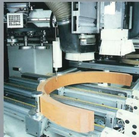
Pressatore meccanico con disco a sfere o con disco cromato.
