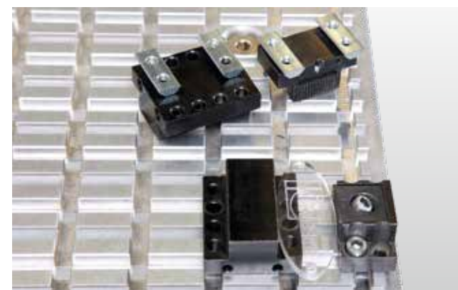
Tavolo a reticolo in alluminio con scanalature a forma di trapezio per il bloccaggio di tutti i tipi di dispositivi di bloccaggio.
