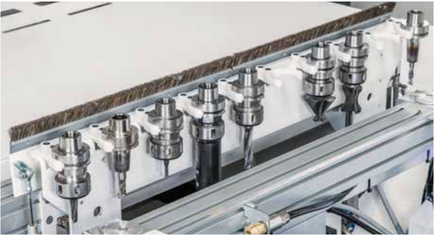
Magazzino lineare ▪ Magazzino cambia utensili aggiuntivo con 10 posizioni (opzionale), sul lato sinistro del basamento della macchina
