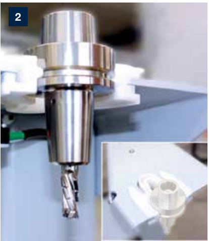
Posizione di trasferimento utensili ▪ Attrezzaggio sicuro e veloce del magazzino cambia utensili ▪ Un sensore di sicurezza verifica se la posizione di cambio utensili è libera oppure occupata per evitare collisioni
