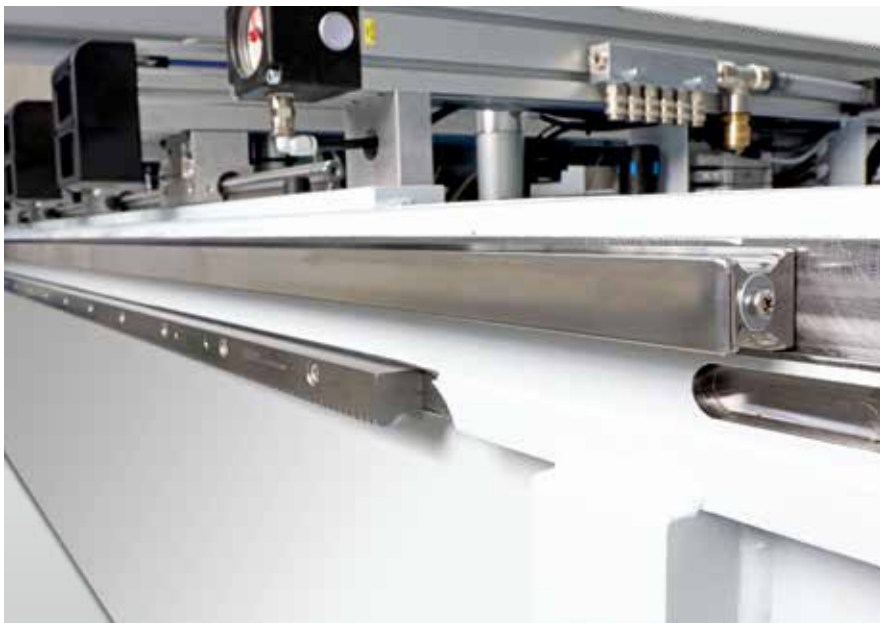
Guide lineari protette Guide lineari di lunga durata con protezione antipolvere. Elevata protezione dalla polvere e da residui di lavorazione. Garanzia per precisione ed affidabilità nel tempo.
