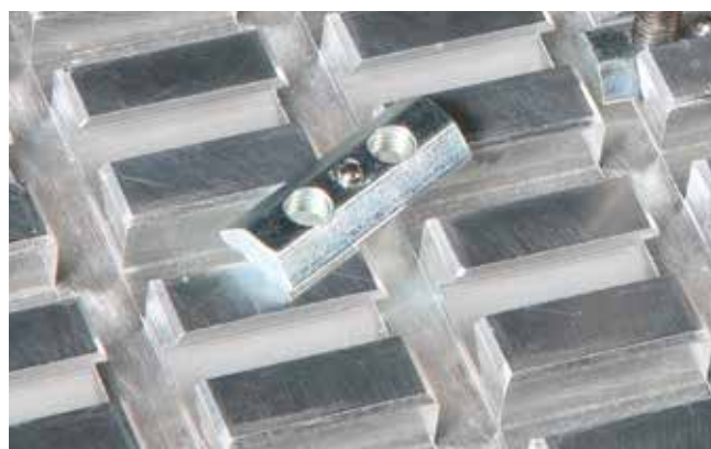
Piastrine di chiusura con filettatura consentono il fissaggio sicuro dei dispositivi di bloccaggio nella guida a coda di rondine.
