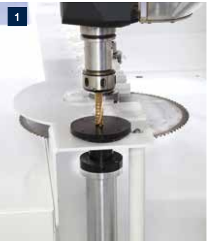
Controllo lunghezza utensile (opzione) ▪ Adatto per la misurazione della lunghezza di utensili a gambo ▪ Dopo l'inserimento dell'utensile sulla posizione di attrezzaggio viene eseguito un controllo della lunghezza e l'aggiornamento della banca dati utensili
