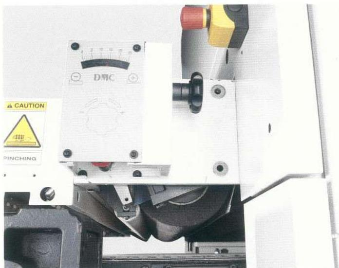
**Gruppo spazzola GS.** Può essere allestito con differenti tipi rulli pulitori o satinatori (diametro 150 oppure 200 mm), anche oscillanti. La possibilità di abbinare due gruppi GS permette di risolvere alla perfezione anche le più complesse esigenze di pulizia/satinatura.
