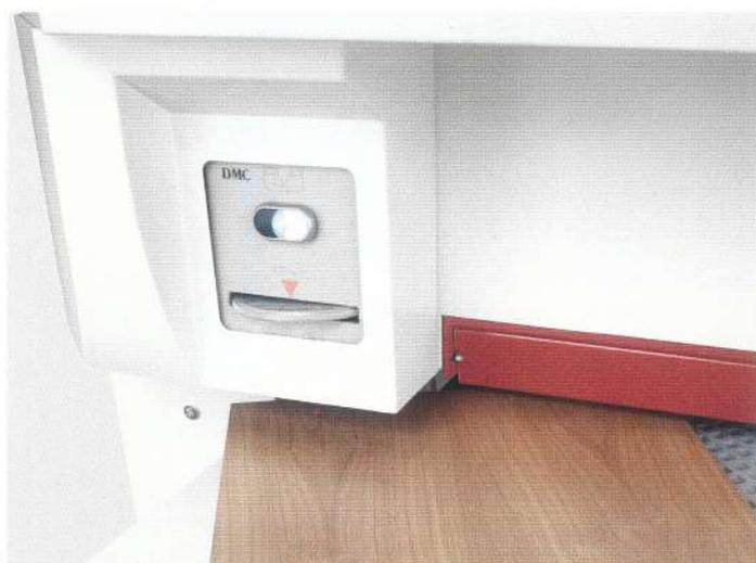
**Posizionatore elettronico del piano di lavoro.** Il sensore elettronico rileva lo spessore del pezzo con estrema precisione e senza necessità di alcun contatto meccanico diretto.
