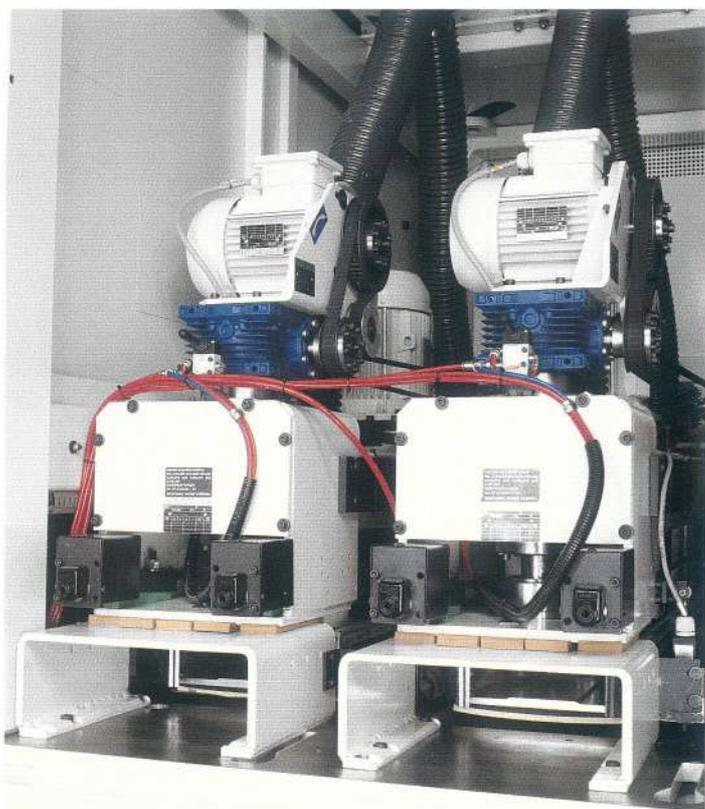
Il pattino orbitante Finesand elimina efficacemente dai traversi le rigature provocate dalla levigatura longitudinale; è dunque la soluzione ideale per la superfinitura dei pezzi sfinestrati (antine da cucina, porte, finestre, etc.) o a venatura incrociata. Con l'abbinamento di due gruppi orbitali è possibile coniugare l'impareggiabile qualità di finitura del pattino Finesand ad un'elevatissima produttività.
