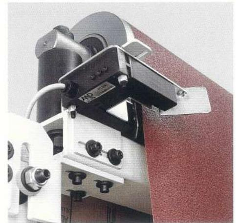
Il sistema di oscillazione con fotocellula a "barriera" non è influenzato dal tipo di nastro o da eventuali deformazioni sui bordi dello stesso. Un soffiatore ad intervento automatico mantiene il dispositivo pulito ed efficiente.
