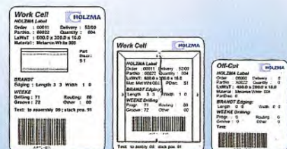
Etikett mit allen wichtigen Werkstückdaten Label carrying all important workpiece data
