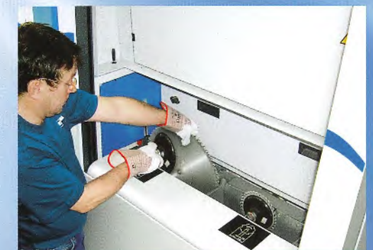
Powerloc Schnellspannsystem Für schnellen, sicheren Sägeblattwechsel Powerloc quick-release clamping system for fast, reliable saw blade changeover
