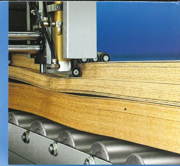
CNC Mikroeinschub auch für dünne Platten CNC micro-infeed for thin panels too
