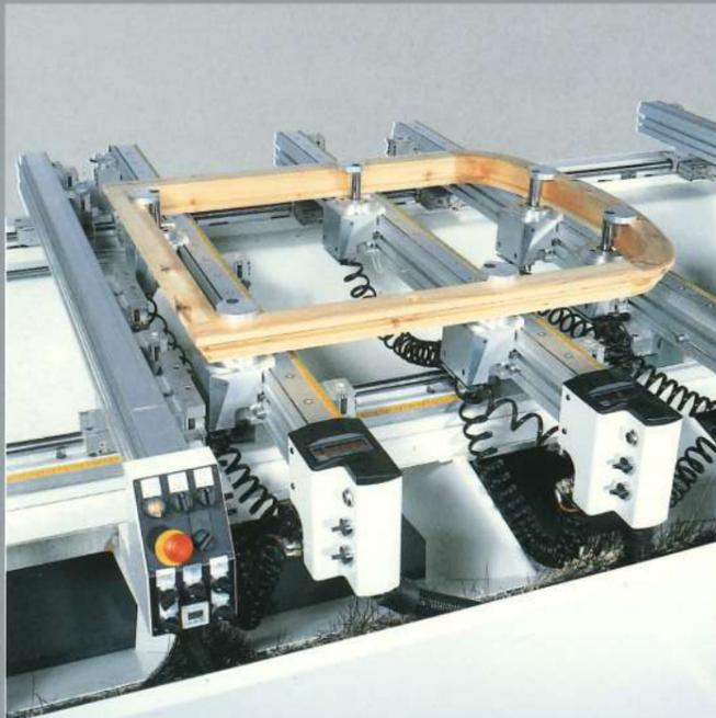
Der Arbeitstisch mit TVN-Auflagen sorgt für eine hohe Flexibilität bei unterschiedlichen Bearbeitungen. Mit dem speziell für die Fensterfertigung entwickelten NWT-System eignet sich der TV-Tisch ideal für die Herstellung aller beliebigen Fenstertypen.
