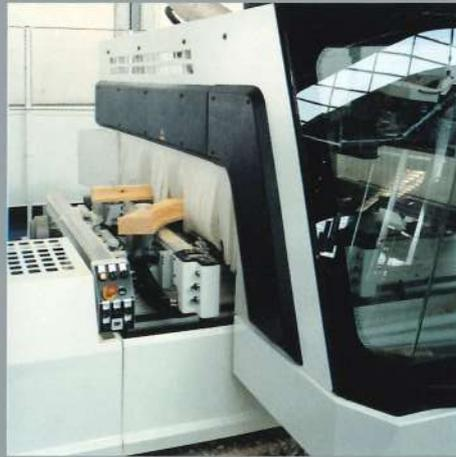
Optimaler Späneschutz und effiziente Absaugung dank der Schutzabdeckungen, die den Aggregateträger vollständig umschließen. Wirksame Spänebeseitigung durch Verkleidungen und Transportbänder zur Abfuhr der Bearbeitungsabfälle.
