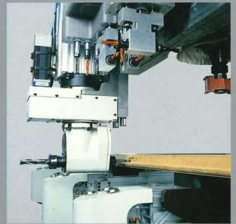
Universal K2 fest oder CNC-gesteuert drehbar von 0-360°, für schwerste Horizontalbearbeitungen.
