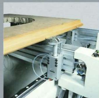
Vakuumsauger für Rahmentelle und Referenzanschlätze für überfurnierte Werkstücke, die den Anforderungen bei der Türenfertigung entgegenkommen.
