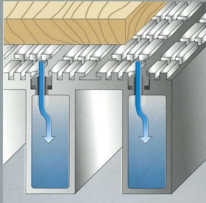
Sichere Werkstückspannung mit höchster Vakuulleistung: Der ideale Tisch für die pneumatische Aufspannung.
