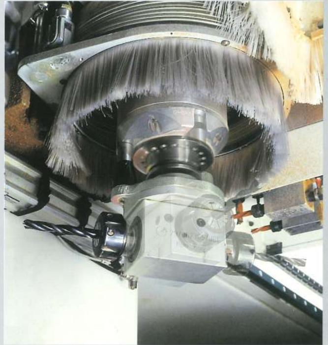
**Vector-Drehachse:** Für den Einsatz von Winkelgetrieben, die durch die CNC-Steuerung von 0-360° stufenlos drehbar sind.
