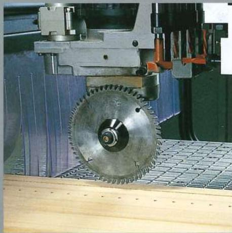
Sägeaggregat drehbar 0-90° oder CNC-gesteuert stufenlos von 0-360°. Schnell und leistungsstark für den Einsatz bei beliebigen Materialien.
