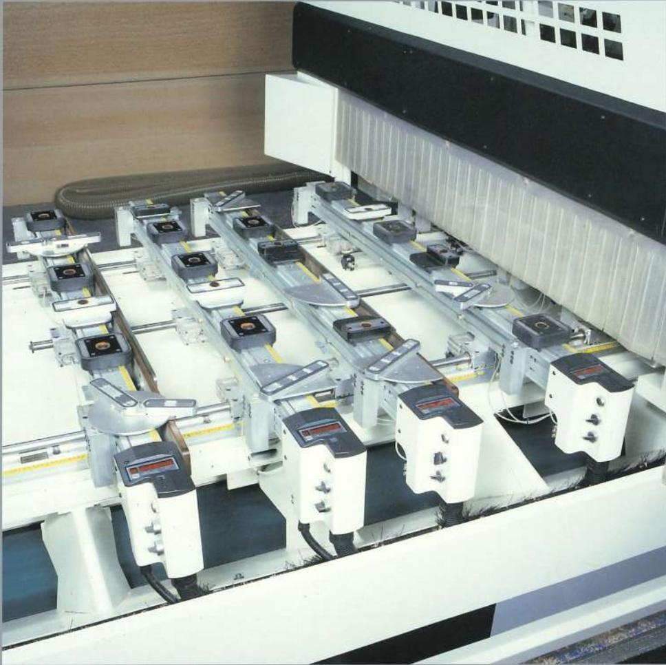
Durch den Arbeitstisch mit TVN-Auflagen können Vakuumsauger je nach Bedarf aufgesteckt oder abgenommen werden. Ebenso ist ein schnelles Umrüsten von Vakuumsaugern auf verschiedene Spannelemente ohne Werkzeug möglich: **Die Befestigung erfolgt vollautomatisch.**
