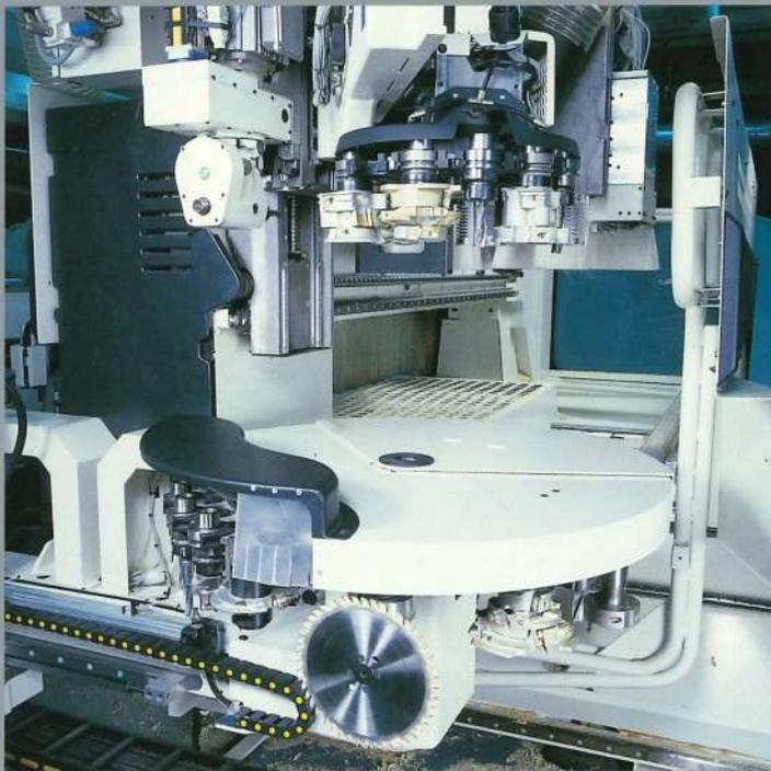
**Werkzeugwechsler TRM** - In der X-Achse mitfahrender Zusatzwerkzeugwechsler mit 24 Plätzen.
