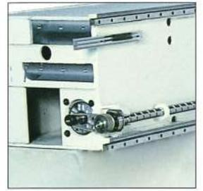
Unter Einsatz modernster CAD-Hilfsmittel projektierte und elektrogeschweißte Stahlkonstruktion. Einzigartige Steifigkeit in dieser Maschinenkategorie.
