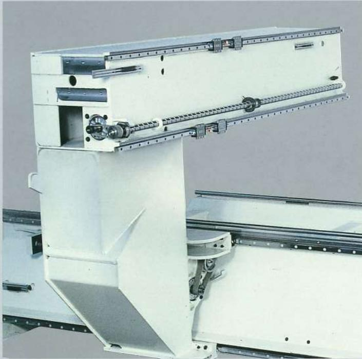
Prismenführungen mit Kugelumlauflager. Maximale Stabilität und optimale Gleiteigenschaften garantieren eine perfekte Bearbeitungsqualität unter allen Arbeitsbedingungen.
