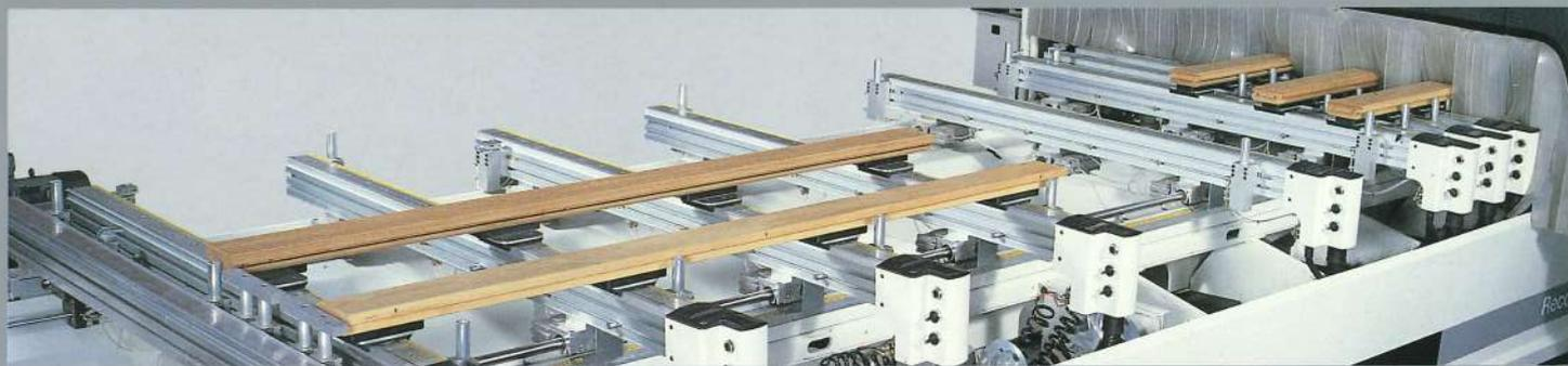
**Spezifische Lösungen.** Speziell für die Türen- und Fensterfertigung entwickelte Anschlag- und Spannsysteme.
