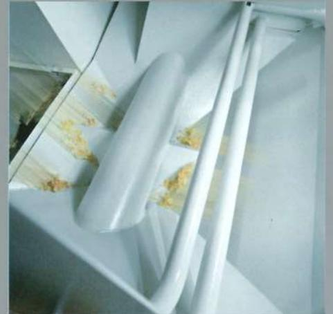
Zusätzliche Absaugung innerhalb der Schutzabdeckung.
