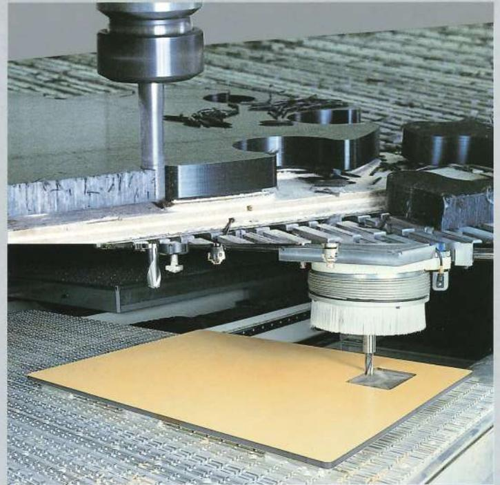
Die hohe Verwindungssteifigkeit und die ebene Auflagefläche des Multifunktionszisches aus Aluminium sind auch ideal für die Bearbeitung von Kunststoff und Leichtmetall.
