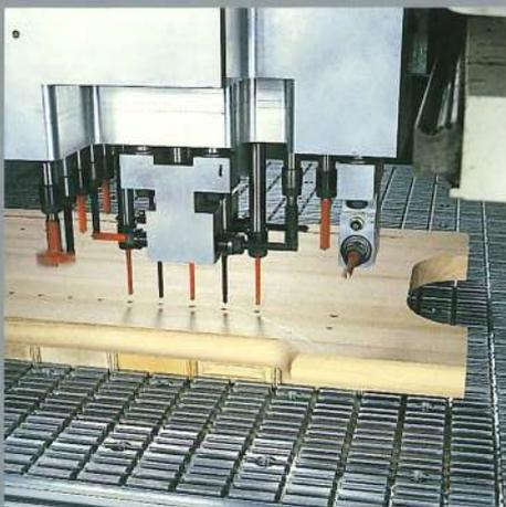
Bohraggregate mit 9, 18 oder 26 unabhängigen Bohrspindeln.
