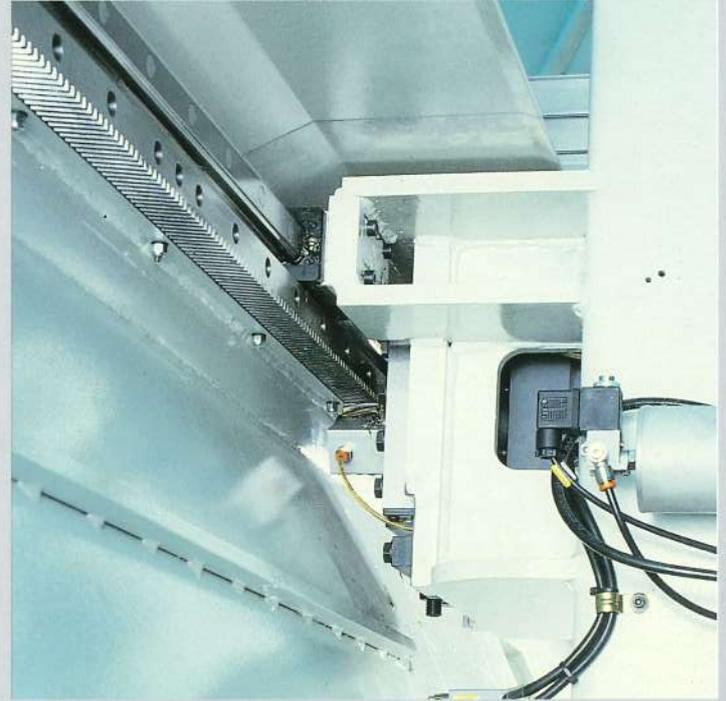
Schrägverzahnte Präzisionszahnstange und Spielausgleichssystem bieten höchste Präzision bei Bewegungen mit hohen Geschwindigkeiten.
